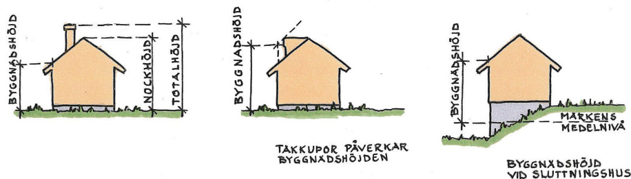
Bild 56. Illustration över hur byggnadshöjd respektivenockhöjd mäts.
